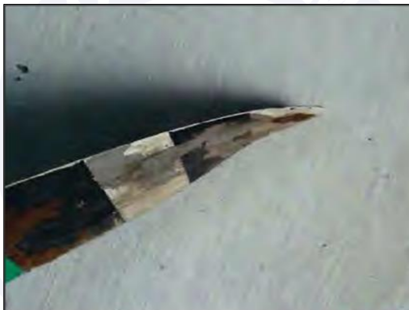
Figura 23 - Pá da hélice com a extremidade dobrada para a frente.
