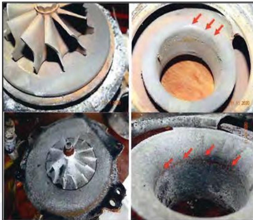
Figura 24 - Marcas de roçamento deixadas sobre a carcaça.
