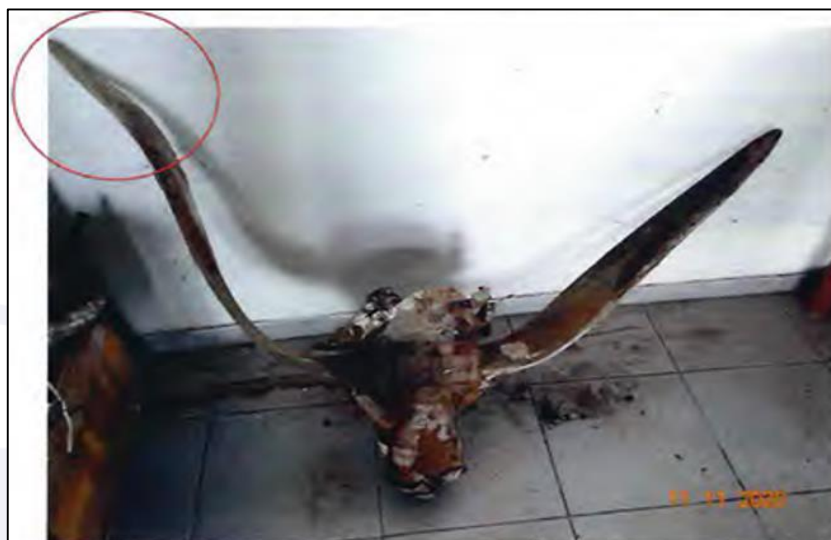
Figura 26 - Vista da hélice com uma das pás com dobramento voltado para a frente.
