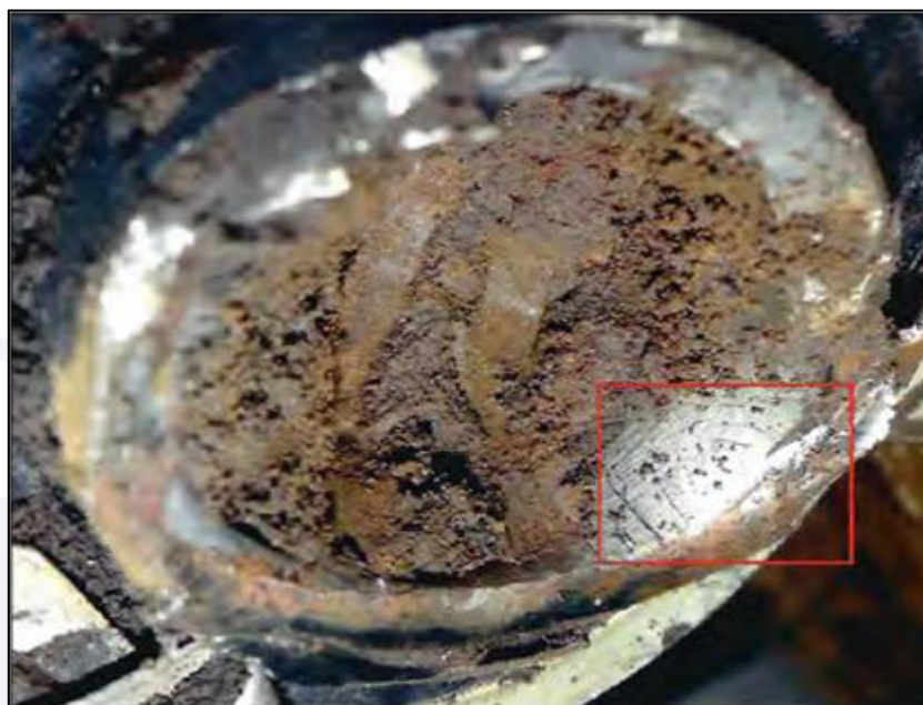
Figura 22 - Estrias na região da fratura existente no eixo de manivelas.
