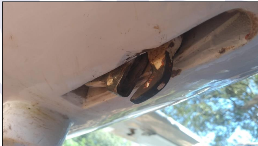
Figura 4 - Gancho de reboque do planador.
