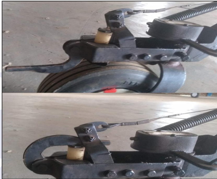
Figura 5 - Funcionamento do gancho da aeronave rebocadora.
