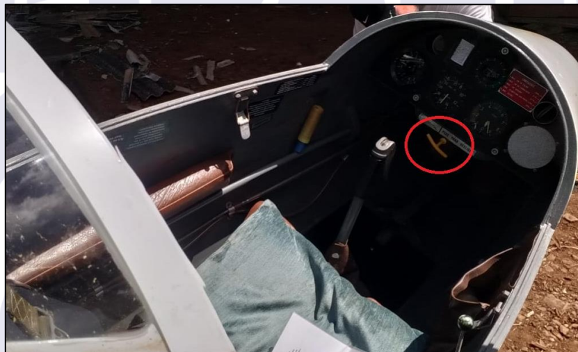
Figura 3 - Haste de comando para o desligamento do cabo de reboque.
