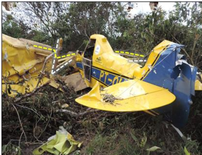
Figura 2 - Detalhe dos montantes das asas e conservação do cockpit .
