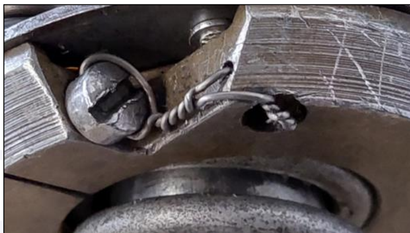
Figura 12 - Parafuso frenado na Tension Nut .
