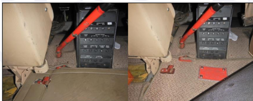
Figura 2 - À esquerda, a foto do tapete na posição em que se encontrava no acidente e, à direita, a placa aparecendo após o tapete ser dobrado manualmente.
