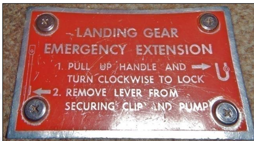
Figura 3 - Placa encoberta pela tapeçaria.
