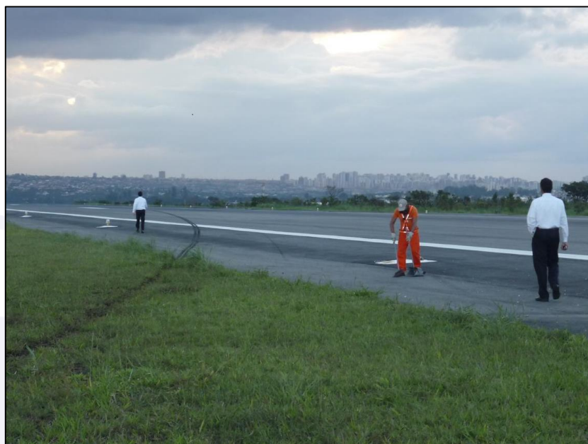
Figura 3 - Marcas deixadas pelo pneu do trem de pouso direito na pista e na área gramada adjacente.
