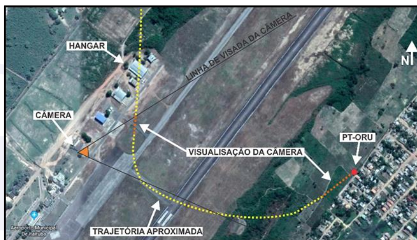
Figura 2 - Croqui do acidente, com a linha de visada da câmera de segurança e trajetória aproximada da aeronave até o impacto.
