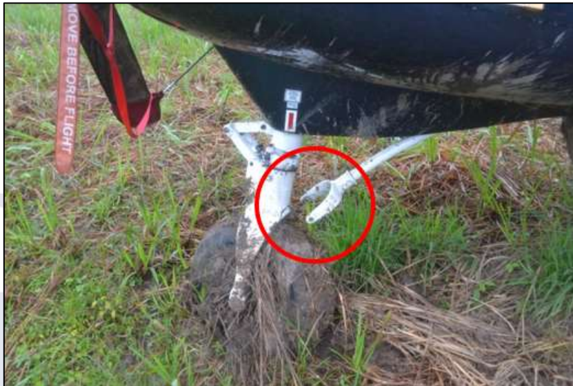
Figura 3 - Garfo do trem de pouso auxiliar solto.
