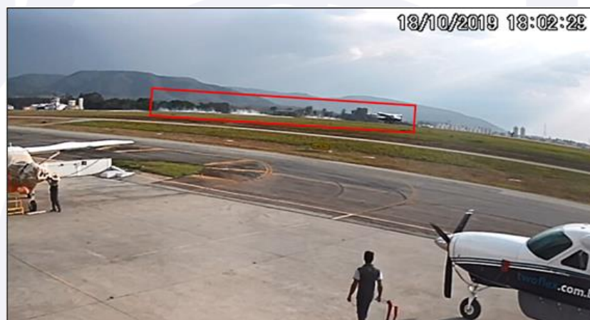
Figura 19 - Imagem mostrando a fumaça produzida pelo travamento das rodas dos trens de pouso principais.
