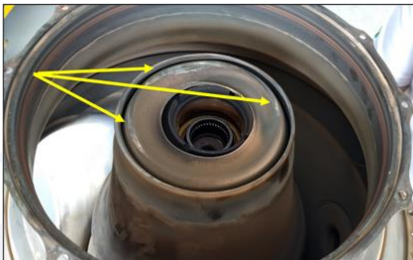
Figura 9 - Parte traseira do Exhaust Duct com marcas de atrito/roçamento, sinalizadas com as setas amarelas.
