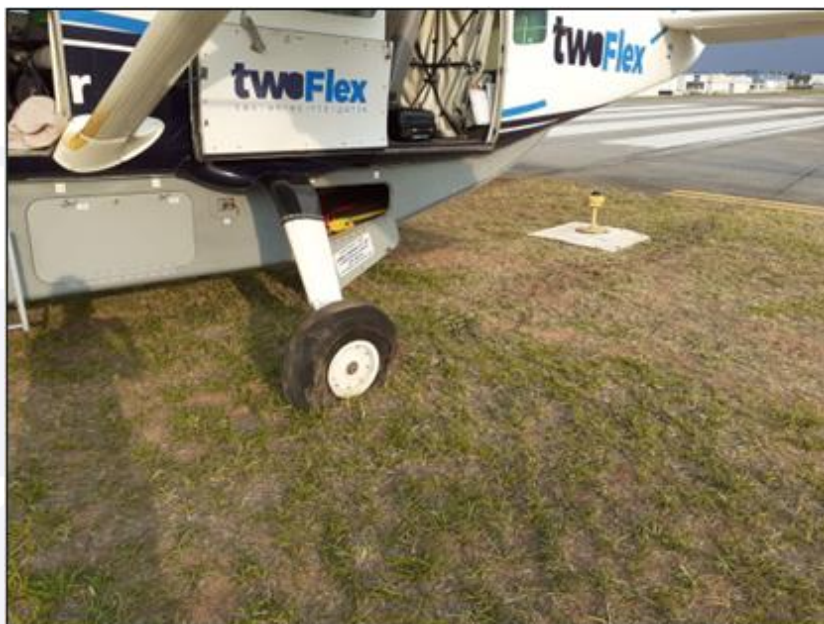
Figura 2 - Imagem da lateral esquerda da aeronave. É possível observar o dano no conjunto da roda e pneu, bem como a posição final da aeronave após o limite da pista.
