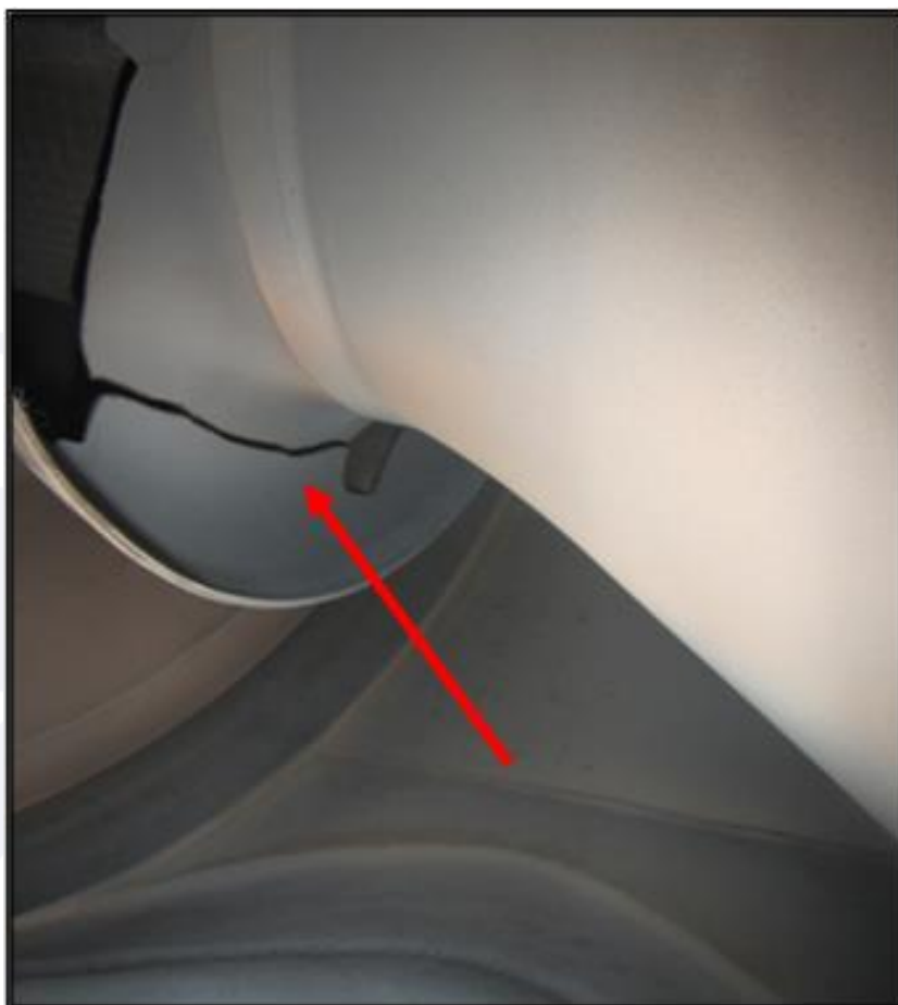
Figura 7 - Imagem aproximada do interior do Exhaust Duct . A seta indica a região danificada.
