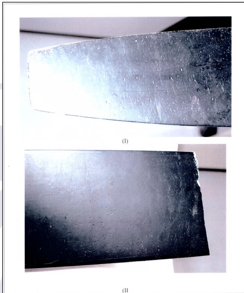
Figura 5 - Várias marcas de impacto na pá não fraturada (I) e também na pá fraturada (II).
