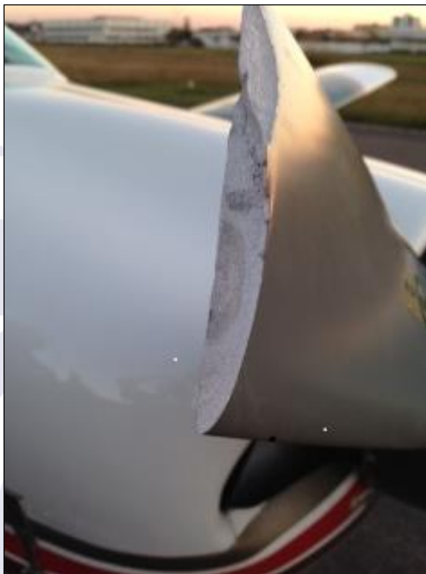
Figura 3 - Detalhe da fratura da hélice.
