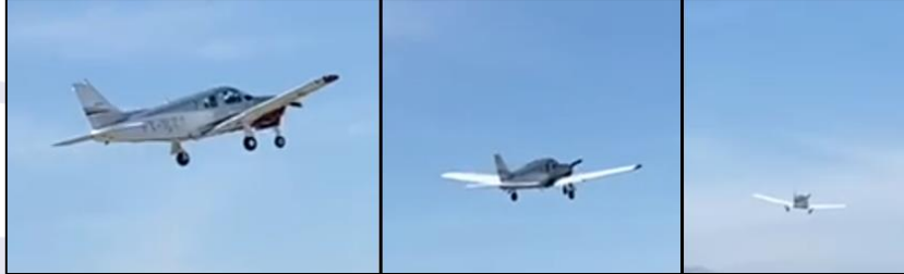
Figura 3 - Da esquerda para a direita, observa-se a aeronave com trem baixado e flapes em 25°, em ascensão até recolher flapes e trem, quando passa a perder altura.
