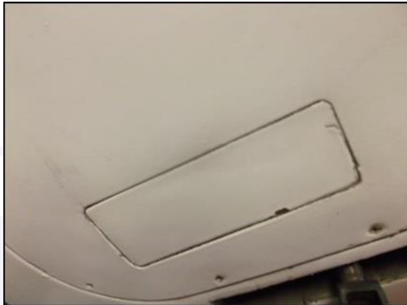
Figura 4 - Vista externa do small flap completamente fechado, após acionamento manual.
