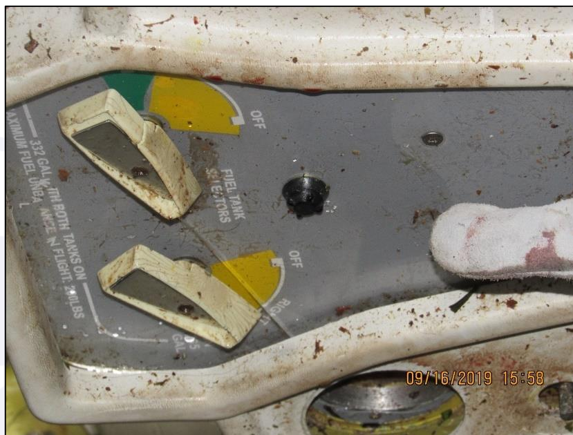
Figura 28 - Vista aproximada do painel das seletoras de combustível. As seletoras foram movimentadas pelo impacto.
