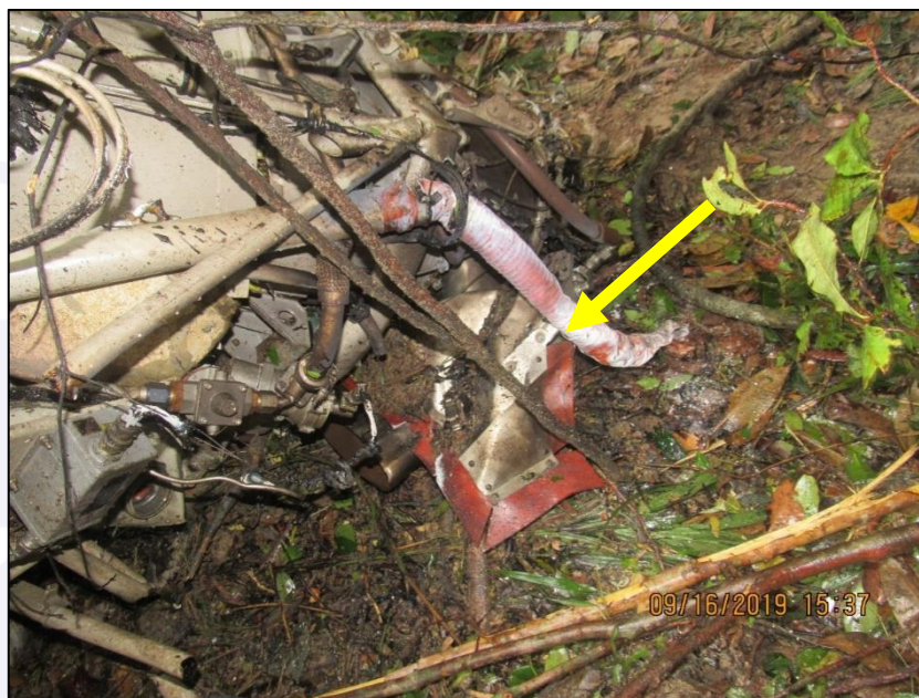
Figura 29 - Vista aproximada da parte direita do motor da aeronave. A seta amarela mostra a presença do pó branco onde houve a utilização do extintor de incêndio.
