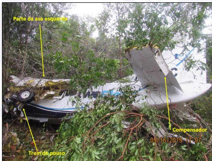
Figura 23 - Vista aproximada da aeronave após a parada total. As setas amarelas indicam a posição da perna do trem de pouso esquerdo, o compensador de profundor quebrado e a parte da asa esquerda que dobrou para cima da aeronave.
