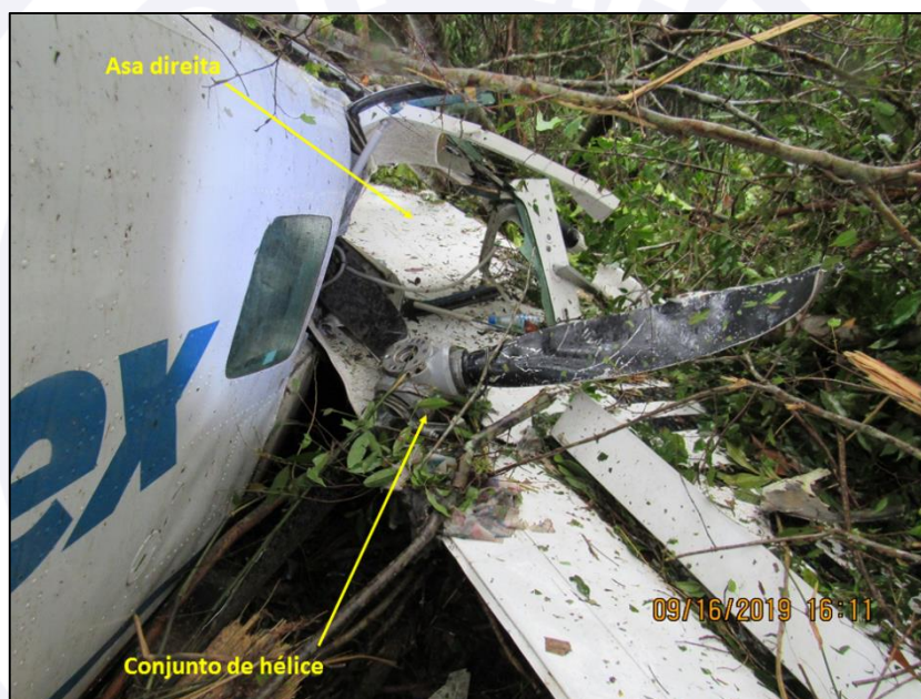
Figura 25 - Vista aproximada da lateral direita da aeronave, próximo a porta de passageiros. Nos detalhes, a posição da asa direita e a posição final do conjunto de hélice.
