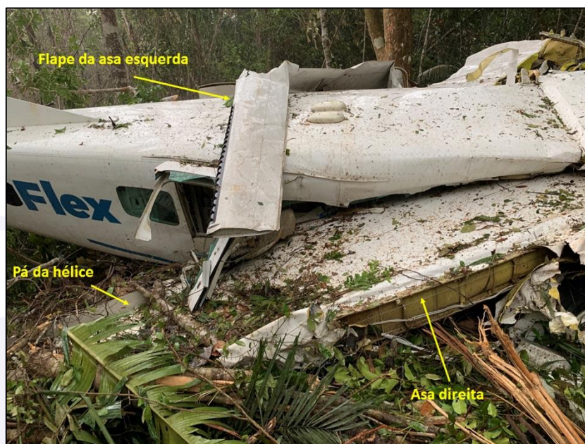
Figura 24 - Vista aproximada da lateral direita e da parte superior da aeronave. Nos detalhes, a posição da asa direita, do flape da asa esquerda e uma pá do conjunto de hélice.
