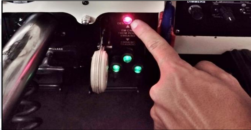
Figura 4 - Cheque de luzes do sistema de posicionamento do trem.
