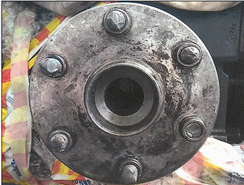
Figura 3 - Parafusos do flange de fixação da hélice esquerda fraturados.
