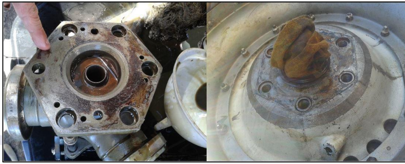
Figuras 6 - Ausência do shim entre o flange de fixação da hélice no motor e o cubo da hélice direita.
