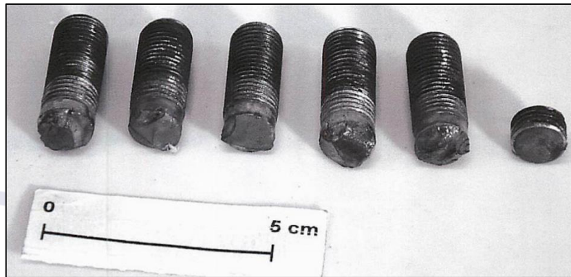
Figura 4 - Parafusos do flange de fixação da hélice, após a remoção.
