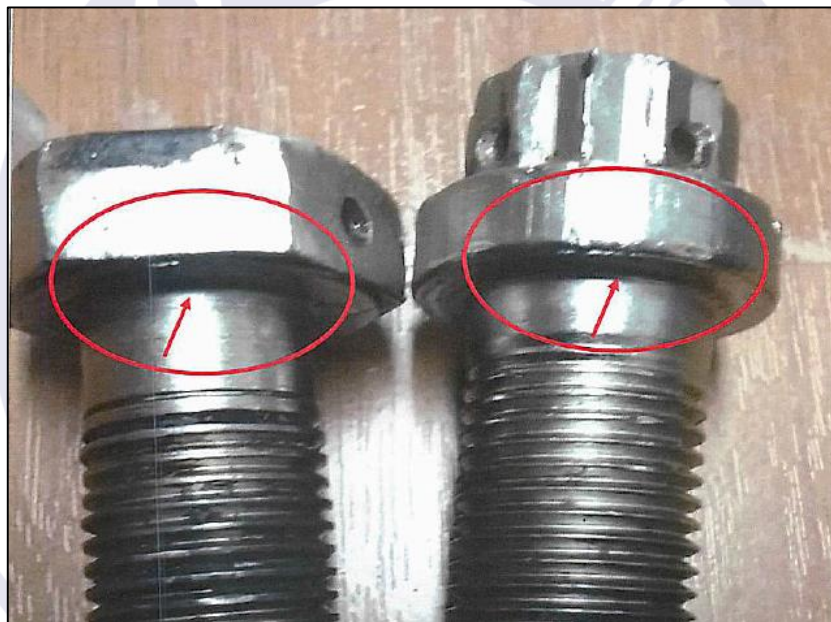
Figura 4 - Parafusos semelhantes pertencentes ao motor direito, com destaque para o local onde se iniciaram as trincas nos parafusos rompidos da hélice esquerda.
