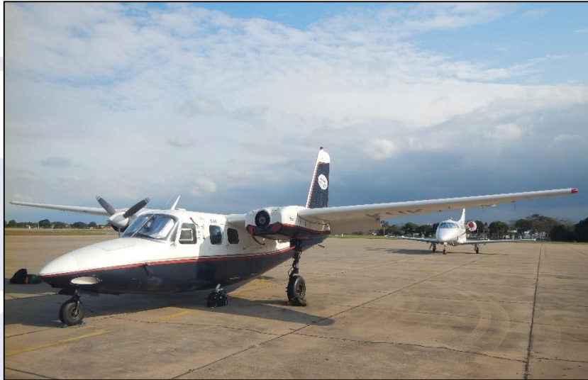
Figura 2 - Vista geral da aeronave sem o conjunto de hélice do motor esquerdo.
