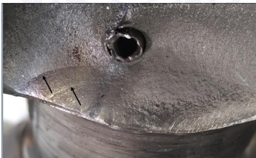
Figura 9 - Exame por estereoscopia. No detalhe da superfície de fratura, observam-se marcas de praia indicativas de fadiga (setas).
