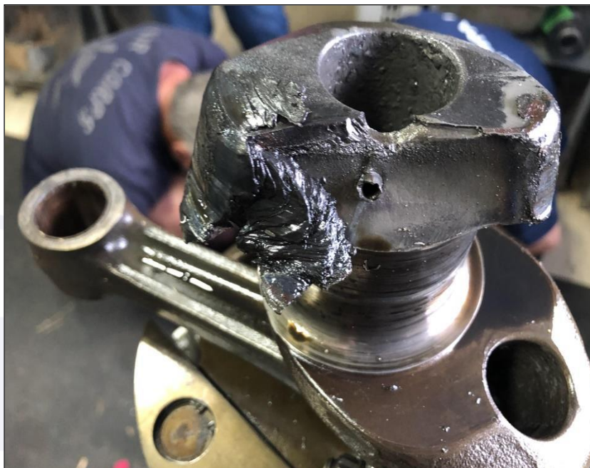
Figura 7 - Fratura no eixo de manivelas.
