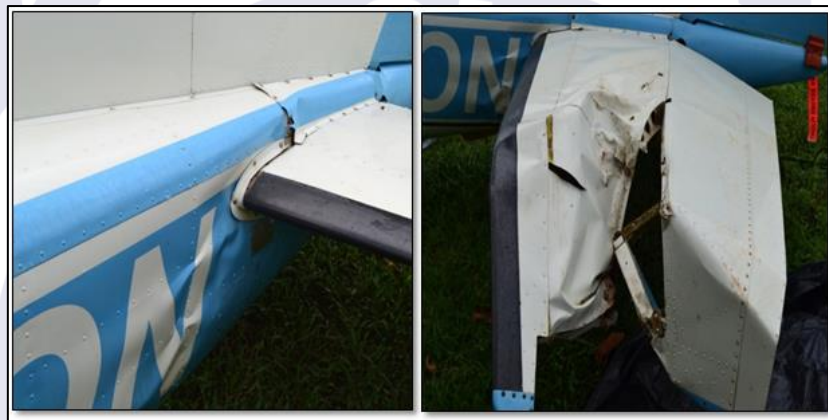
Figuras 12 e 13- vista aproximada da seção traseira da aeronave. No detalhe, na foto da esquerda, identificam-se os danos no cone de cauda e fuselagem esquerda. A foto da direita apresenta os danos acarretados no estabilizador horizontal esquerdo, em decorrência do impacto da aeronave com a vegetação.
