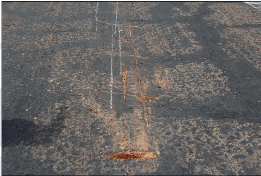
Figura 2 - Marcas deixadas pelas pás da hélice e pela fuselagem na pista.
