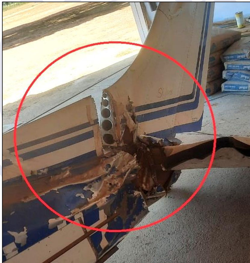
Figura 5 - Vista dos danos ao estabilizador vertical da aeronave, após o rompimento dos rebites de fixação.
