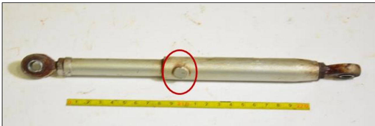
Figura 4 - Foto da haste removida da aeronave. No detalhe em vermelho, o safety pin que não se rompeu e não permitiu que o procedimento de emergência fosse realizado.
