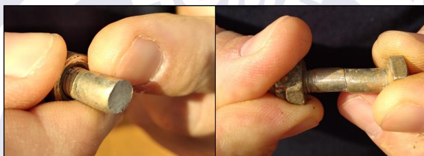
Figura 4 - Detalhe do parafuso de fixação do trem de pouso com características de cisalhamento.
