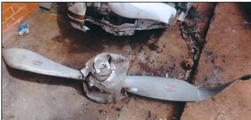
Figura 8 - Dobramento nas pás da hélice.
