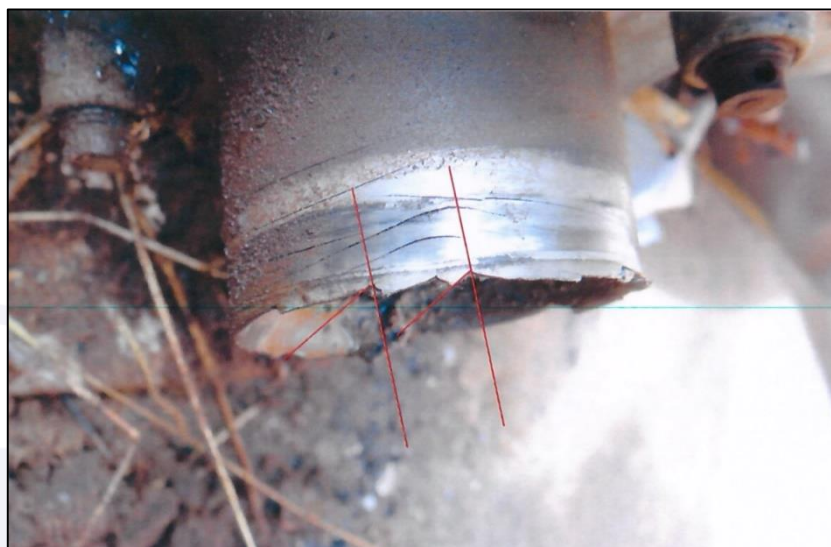
Figura 7 - Trincas de ruptura do eixo de manivelas.
