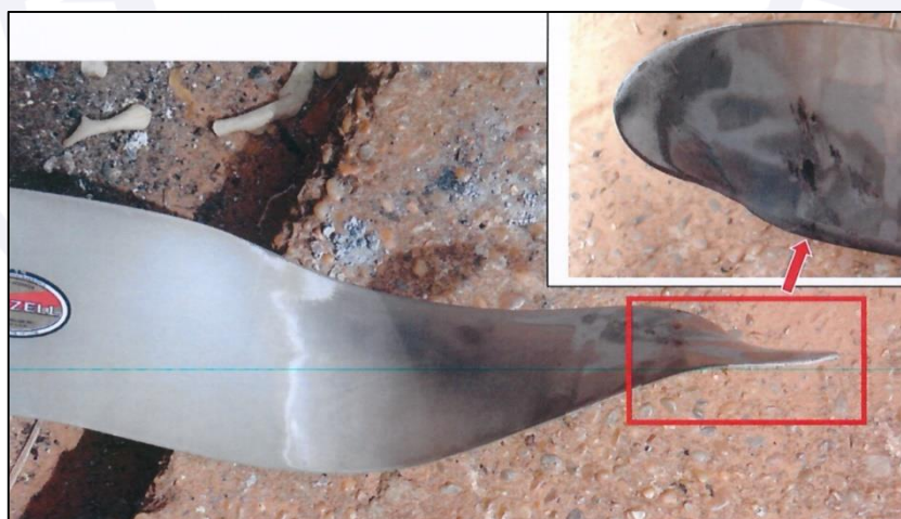
Figura 9 - Detalhe do dano na pá que dobrou para a frente.
