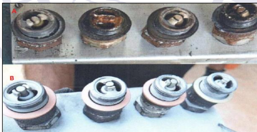
Figura 4 - Velas dos cilindros nº 2 e 4 antes (A) e depois da limpeza (B).
