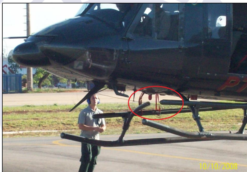
Figura 1 - Vista da aeronave no pairado com o esqui quebrado.
