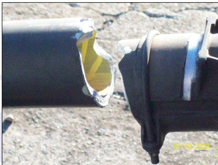
Figura 2 - Detalhe da fratura do montante transversal do esqui da aeronave.
