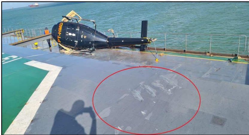
Figura 5 - Marcas de contato do rotor de cauda no helideque.
