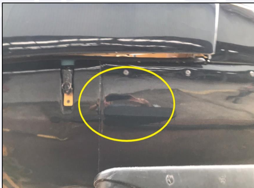
Figura 3 - Amassamentos concentrados na fuselagem abaixo da porta esquerda.
