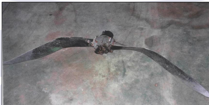
Figura 7 - Vista geral da hélice com as pás dobradas para trás.
