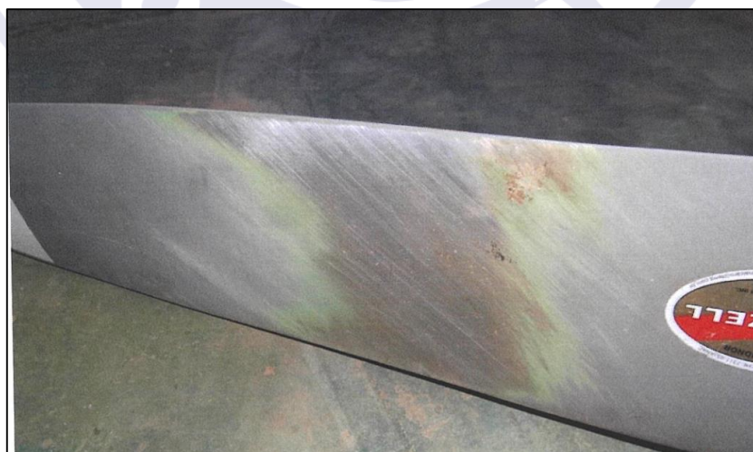
Figura 9 - Vista aproximada do risco observado na outra pá.
