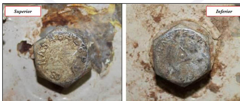
Figura 16 - Vista das cabeças dos pinos com identificação diferente.
