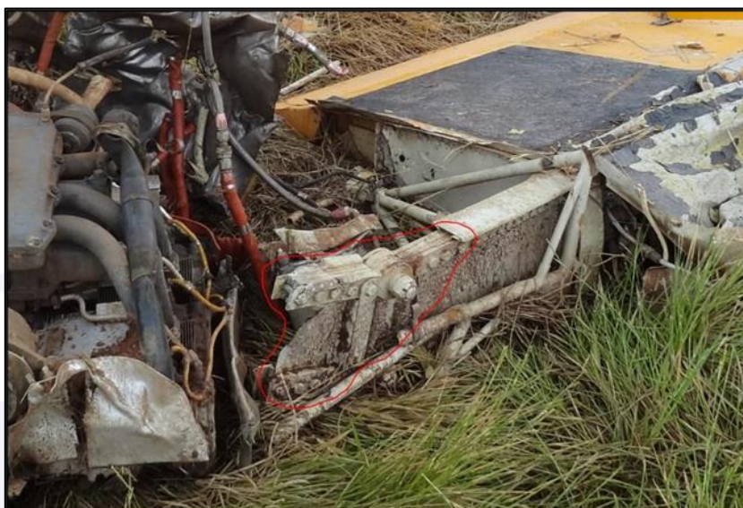
Figura 9 - Vista do caixão central das semiasas.
