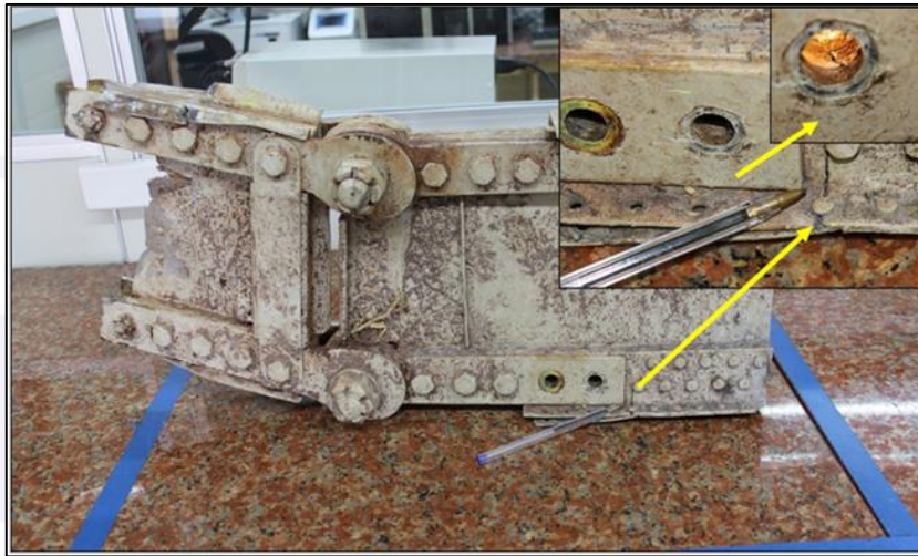
Figura 17 - Região da trinca na semiasa esquerda.
