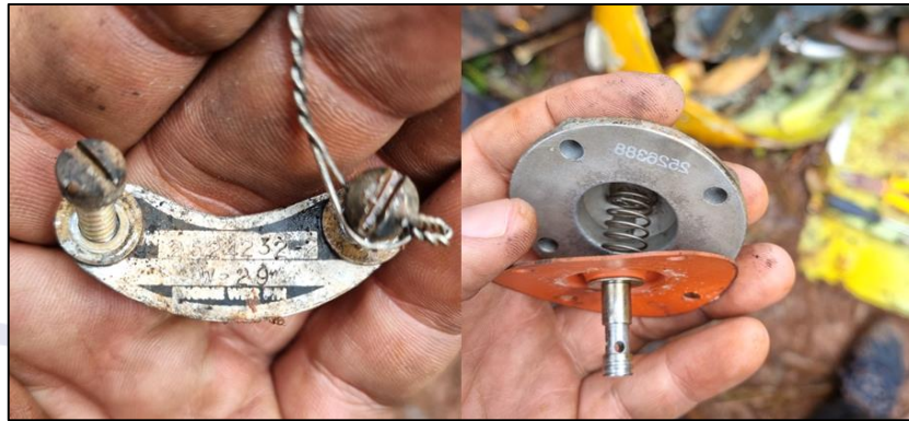
Figura 8 - Detalhe do diafragma da distribuidora.
