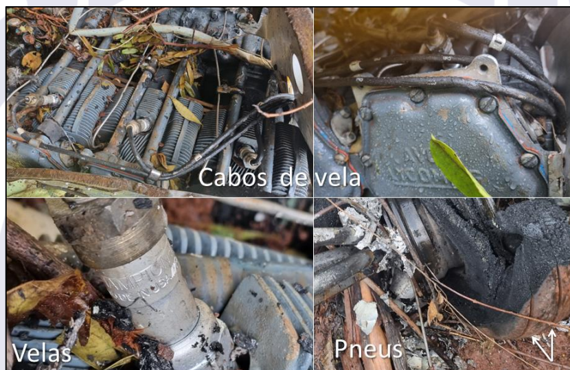
Figura 9 - Condições gerais dos cabos de velas e pneus.
