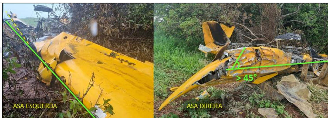
Figura 4 - Detalhe do plano de asas da aeronave e angulação de contato com o solo.
