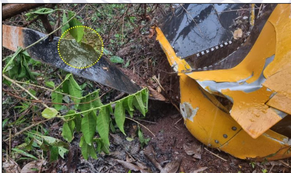
Figura 6 - Detalhe do dano em uma das pás da hélice.
