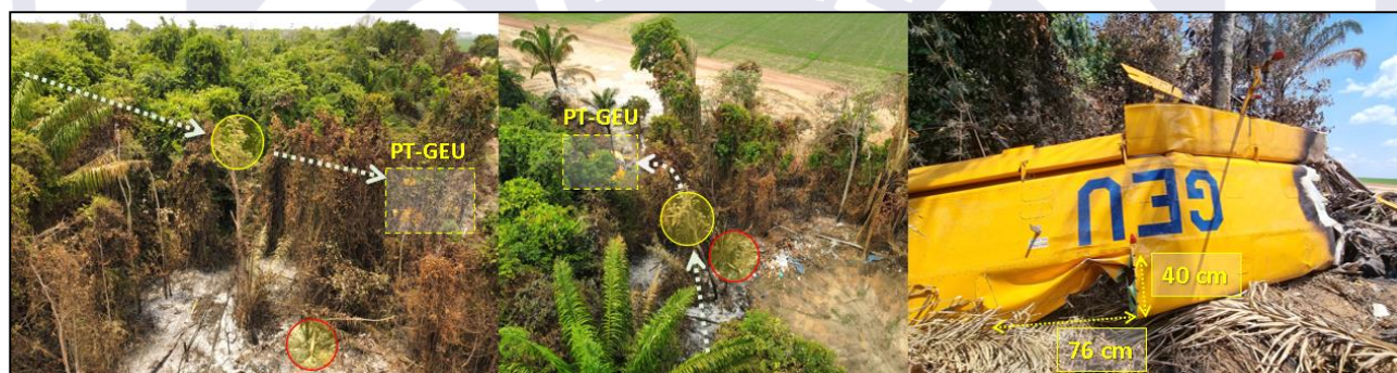
Figura 4 - Perfil aproximado do voo, contato com a vegetação alta e detalhe do dano na aeronave.
