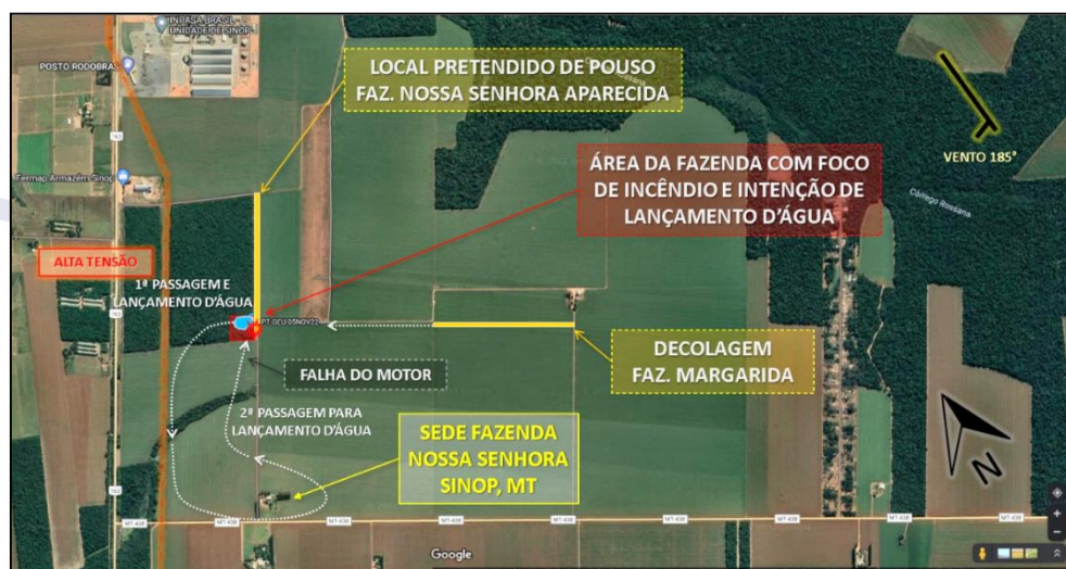
Figura 3 - Croqui da área, perfil aproximado de voo e posicionamento final da aeronave.
