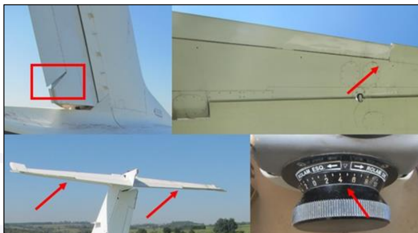
Figura 21 - Imagem dos compensadores de leme, profundor e aileron defletidos.
