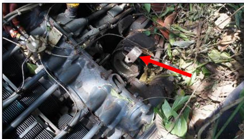
Figura 3 - Bloco do motor fraturado na base do cilindro nº 2 e cabeça da biela fraturada.
