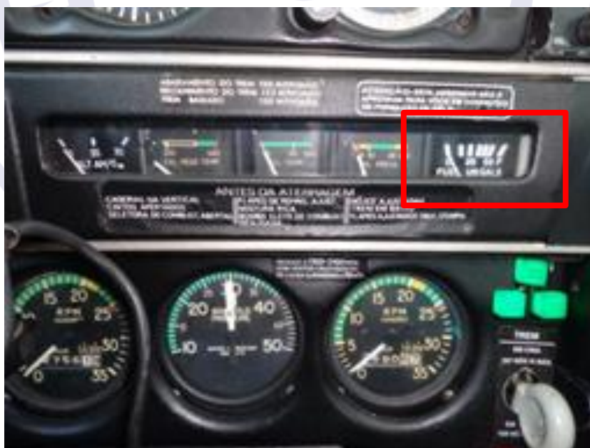
Figura 3 - Liquidômetros sem indicação com a aeronave energizada.
