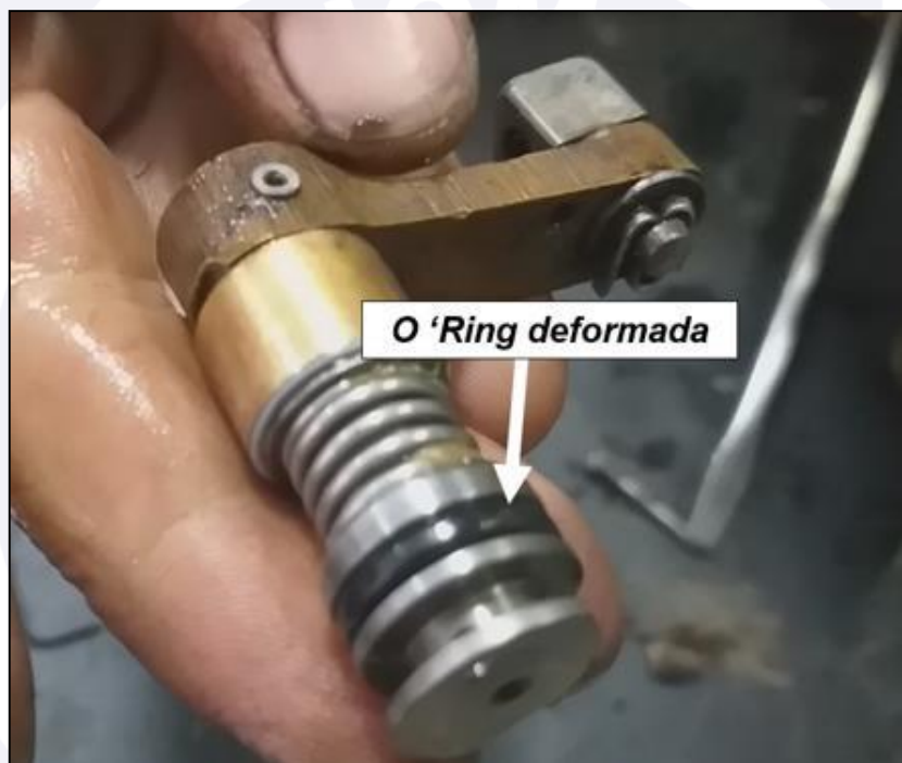
Figura 8 - Aspecto do O-ring do eixo do braço de potência.
