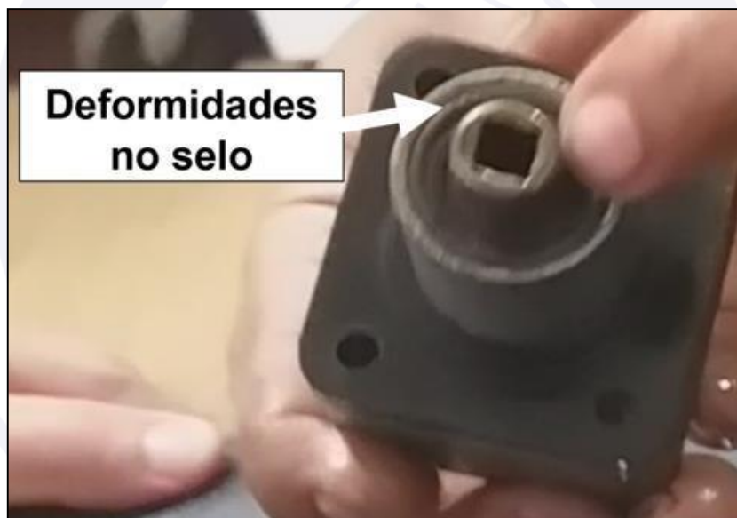
Figura 6 - Selo retentor apresentando deformidades.
