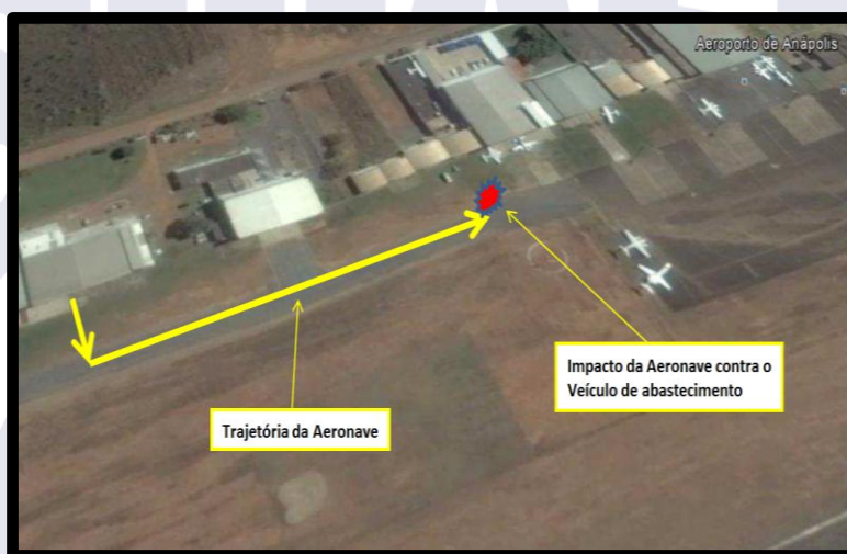
Figura 1 - Trajetória de táxi da aeronave até o impacto com caminhão de abastecimento.
