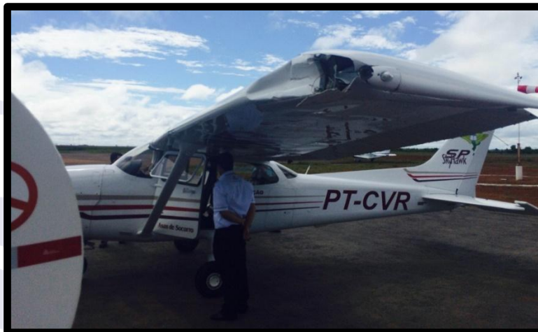
Figura 3 - Danos à ponta de asa da aeronave (foto de terceiros).
