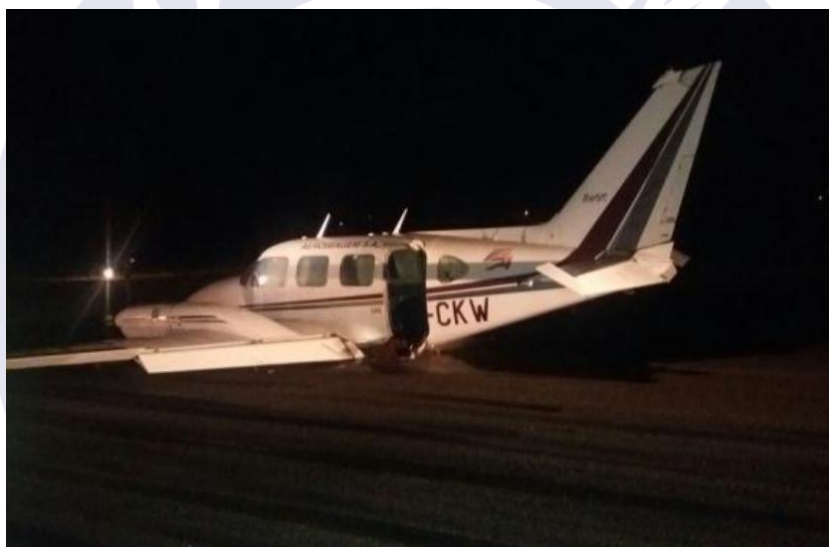
Figura 1 - Aeronave na pista após o pouso com o trem recolhido.
