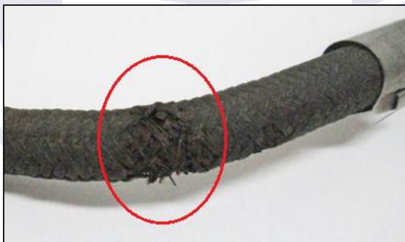
Figura 6 - Detalhe dos danos na mangueira hidráulica do trem de pouso
