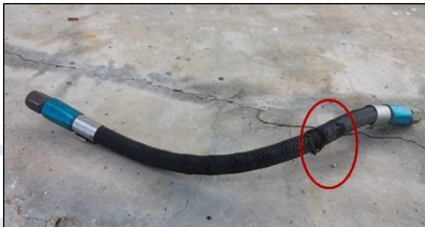
Figura 7 - Estado geral da mangueira P/N 17766-2.
