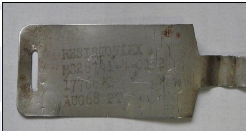
Figura 5 - Placa de identificação da mangueira danificada registra o P/N 17766-2 e especificação MS28741-4-0132.
