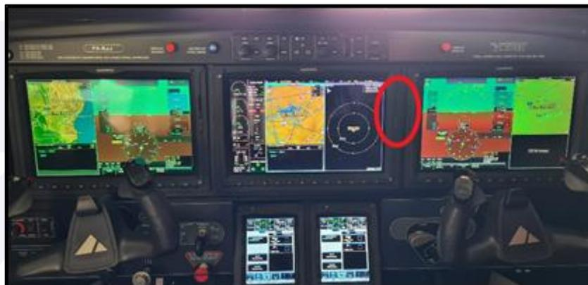
Figura 3 - Painel da aeronave PS-RJJ. Destacada em vermelho, a posição dos *slots* dos cartões SD ao lado do MFD.
