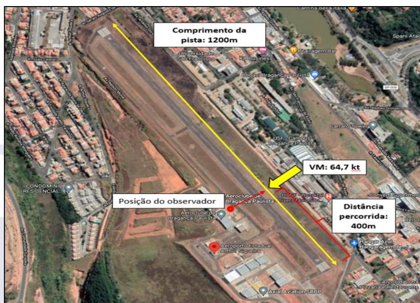
Figura 5 - Distância percorrida e velocidade média da aeronave na ocorrência.
