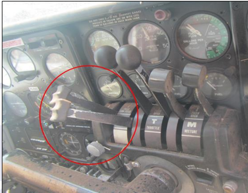
Figura 3 - Posição dos manetes após o acidente com destaque para os de hélice.
