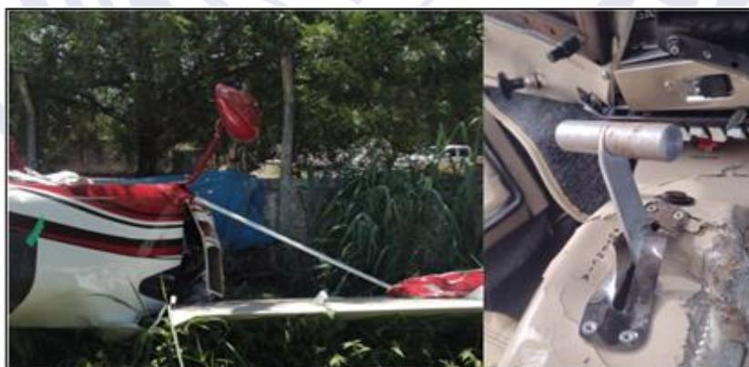
Figura 4 - Imagem mostrando os flapes e o manete de potência.
