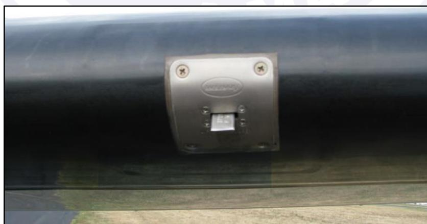
Figura 9 - Transdutor sensor do sistema de alarme de estol.
