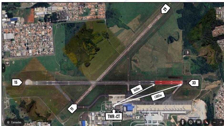
Figura 2 - Imagem satélite com a visão geral de SBCT, destacando a localização da TWR-CT, as cabeceiras das pistas principal (15/33) e auxiliar (11/29), além das distâncias entre a TWR-CT e a cabeceira 33, bem como entre a TWR-CT e o ponto de quase colisão. Em vermelho, o trecho em que ocorreu a incursão em pista.
