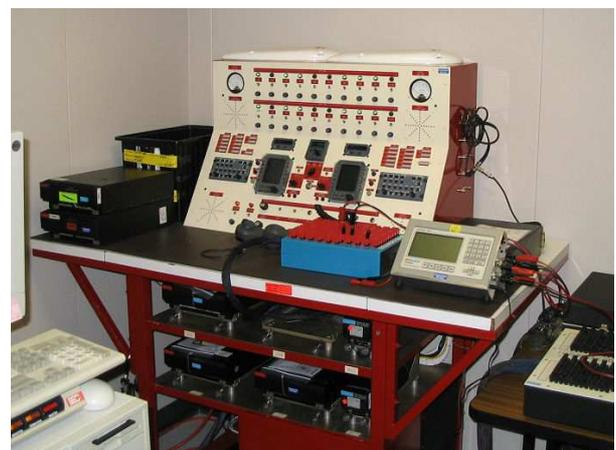
Figura 8. Bancada Primus II (Radio Navegação)
