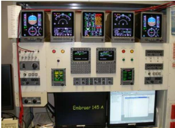
Figura 5. Bancada de integração Primus 1000
