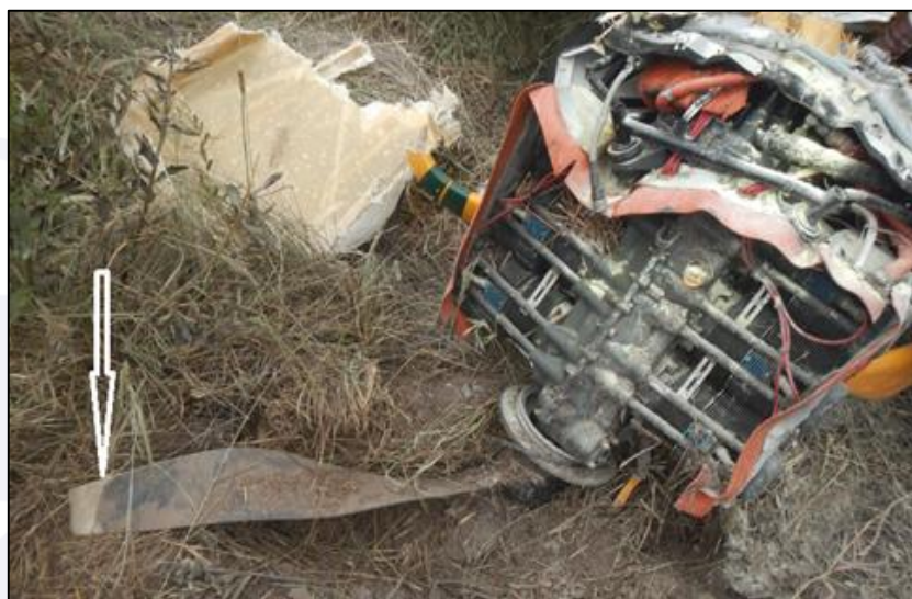
Figura 5 - Vista de uma das pás da hélice, com a indicação de torção e dobramento da extremidade da pá para frente.
