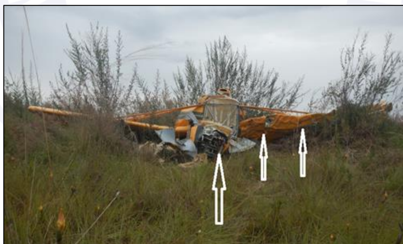
Figura 3 - Vista frontal da aeronave, com indicação das áreas com as avarias mais severas.
