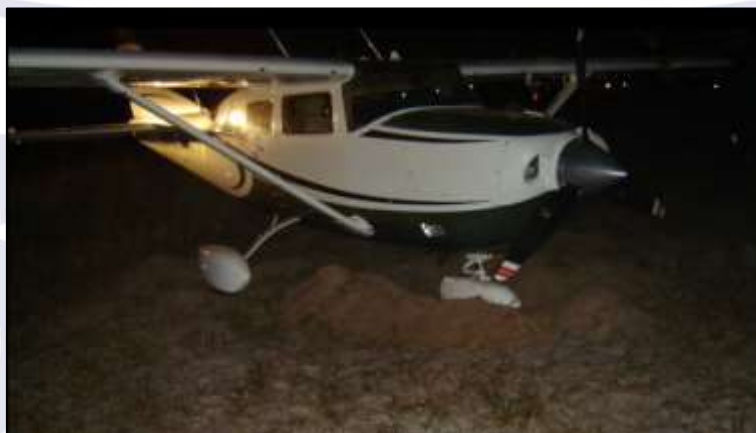
Figura 1 – Vista da aeronave após ultrapassar os limites longitudinais da pista.
