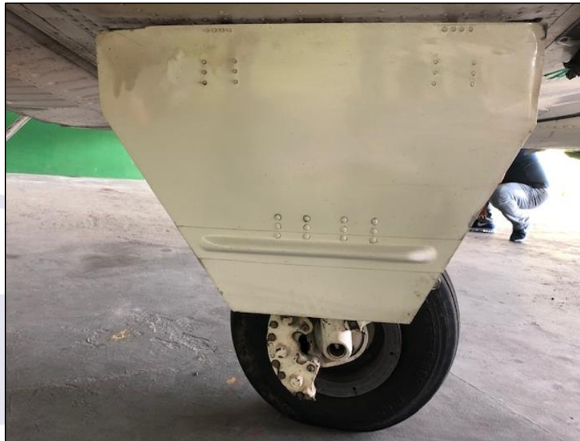
Figura 1 - Vista aproximada da pestana do trem de pouso direito.
