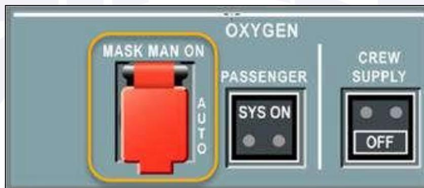
Figura 4 - Painel de oxigênio, em destaque o interruptor vermelho de *MASK ON MAN*.
