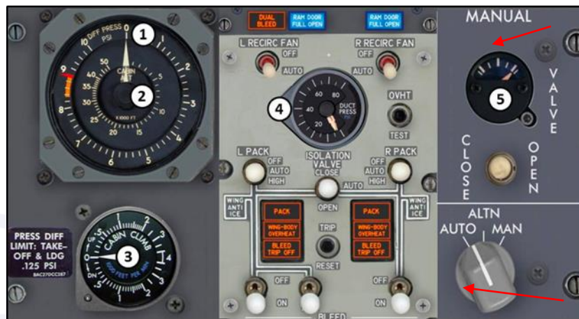
Figura 3 - Recorte do Ovehead Panel com os indicadores do painel de controle do sistema de pressurização e ar condicionado: 1 - diferencial de pressão; 2 - altitude de cabine; 3 - razão de subida/descida da cabine; 4 - pressão nos dutos pneumáticos; e 5 - indicador de posição da válvula Outflow .
