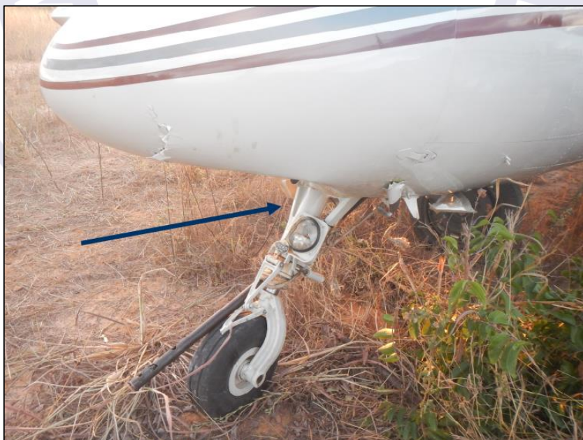
Figura 5 - Danos ao trem de pouso de nariz e fuselagem.
