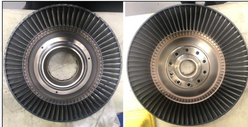
Figura 10 - Power Turbine Disks 1 e 2 do motor SN PCE-ED0604 sem danos significativos.
