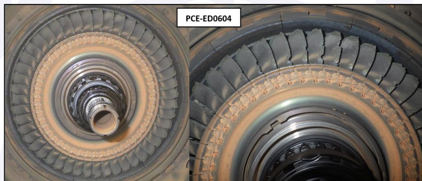
Figura 11 - Low Pressure Turbine Disk do motor SN PCE-ED0604 com todas as blades fraturadas nas extremidades.
