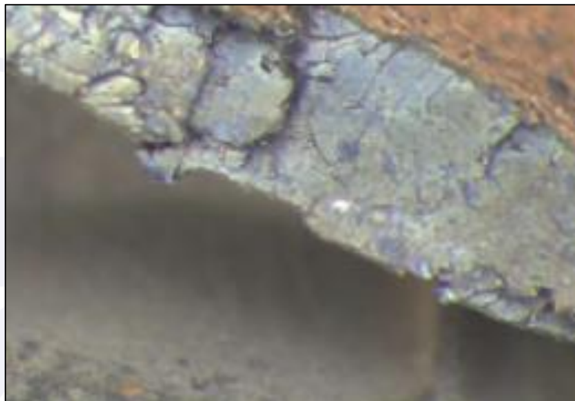
Figura 15 - Superfície fraturada de uma das HP blades do motor SN PCE-ED0550.
