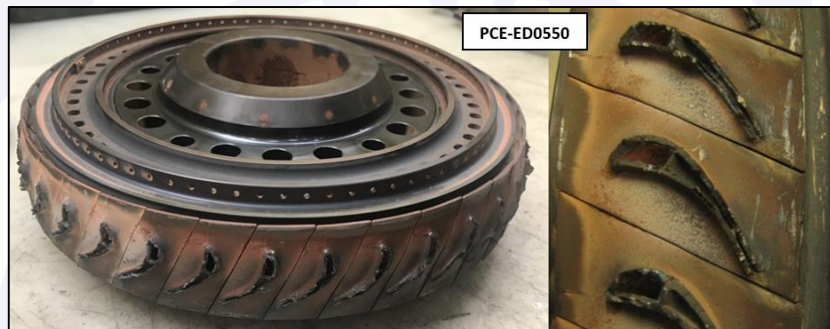
Figura 8 - High Pressure Turbine Disk do motor SN PCE-ED0550 com todas as blades fraturadas nas proximidades da platform e, em sua maioria, com sinais de ruptura por sobrecarga.
