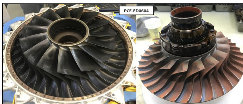
Figura 13 - Low Pressure Impeller e High Pressure Impeller do motor SN PCE-ED0604 sem danos significativos.
