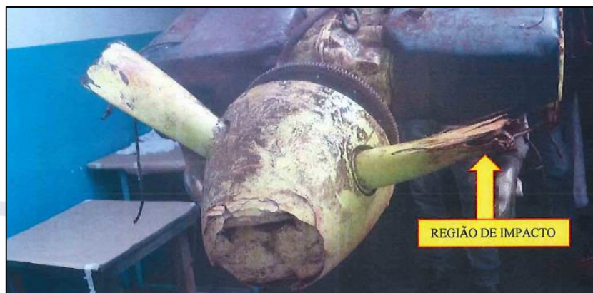
Figura 8 - Vista geral da hélice.
