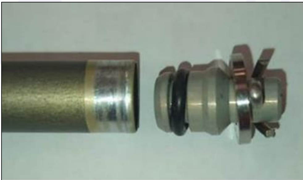
Figura 4 - À direita, o componente do sensor do sistema hidráulico que se desprendeu e caiu no reservatório de óleo, acarretando o acendimento da luz de aviso de baixo nível do sistema hidráulico amarelo.
