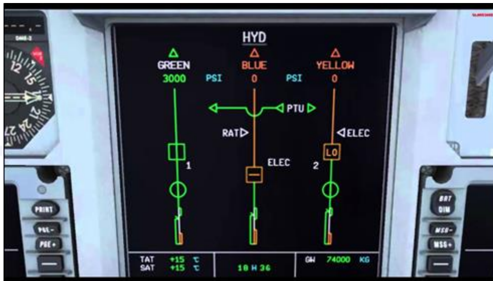
Figura 3 - Página do sistema hidráulico no display do ECAM com dados dos sistemas hidráulicos verde, azul e amarelo.
