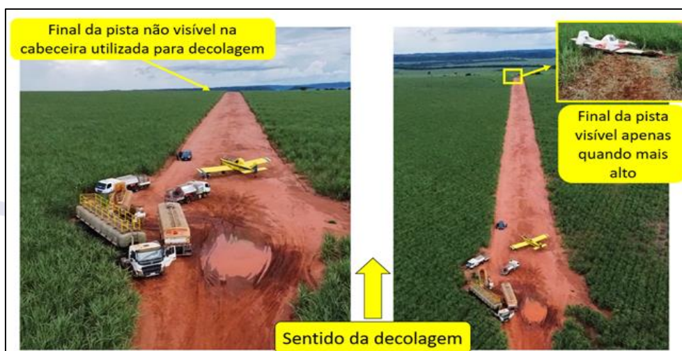
Figura 7 - Variação de nível no sentido da decolagem realizada.
